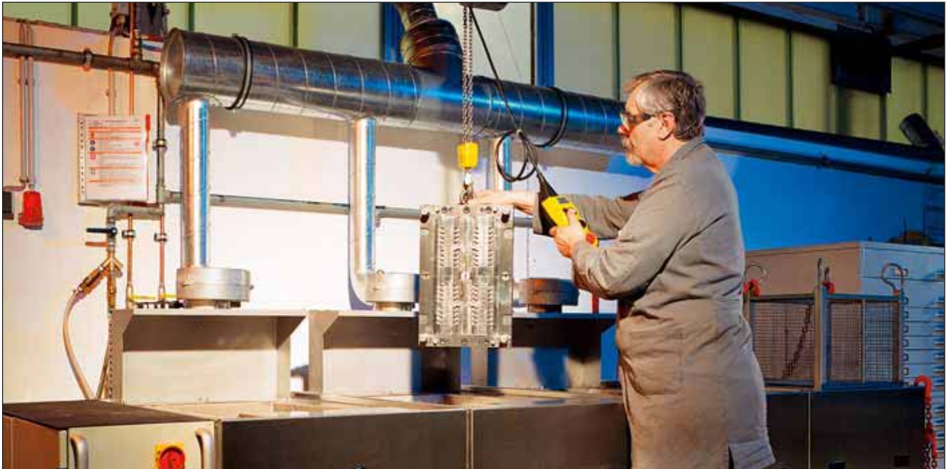
Efficient and environmentally compatible: Ultrasonic cleaning of tools Effizient und umweltschonend: Ultraschall-Reinigung von Werkzeugen
